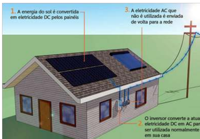
Figura 7 Representação típica da instalação da Energia Solar Fotovoltaica
